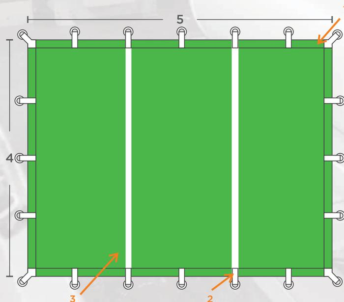
1. Bastilla doble con refuerzo de lona perimetral 2. Refuerzo tipo oreja con remate 3. Cinta de refuerzo de lona
