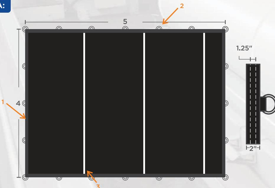
1. Webbing perimetral negro de refuerzo 2. Argolla tipo "D" colocadas con orejas de seatbelt 3. Refuerzo de lona
