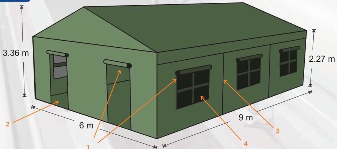
1. Puertas y ventanas con velas 2. Piso en el interior 3. Paredes removibles 4. Ventana de malla de polietileno
