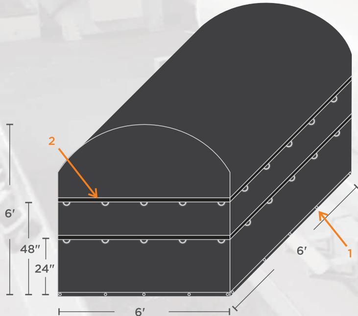
1. Ojillo en perímetro 2. Líneas de argollas tipo "D" a 24" y 48" de altura según requerimientos
